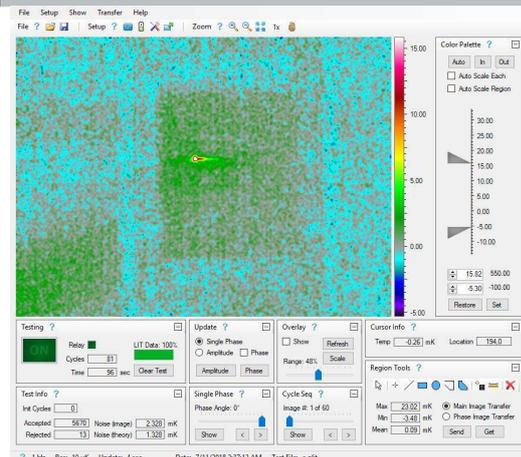
Abbildung 1: Kurzgeschlossener MEMS-Chip. Lock-In-Thermografie: 1Hz-Pulse mit 1V, Strom-limit: 100uA, Kurzschluss-temperatur: ca. 2.5 mK, Hotspot deutlich erkennbar
